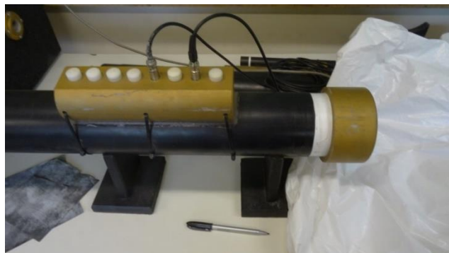
Figura 61: Tudo de impedância para cálculo da absorção acústica.
