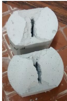
Figura 53: Corpo de prova rompido no ensaio de resistência à compressão diametral.
