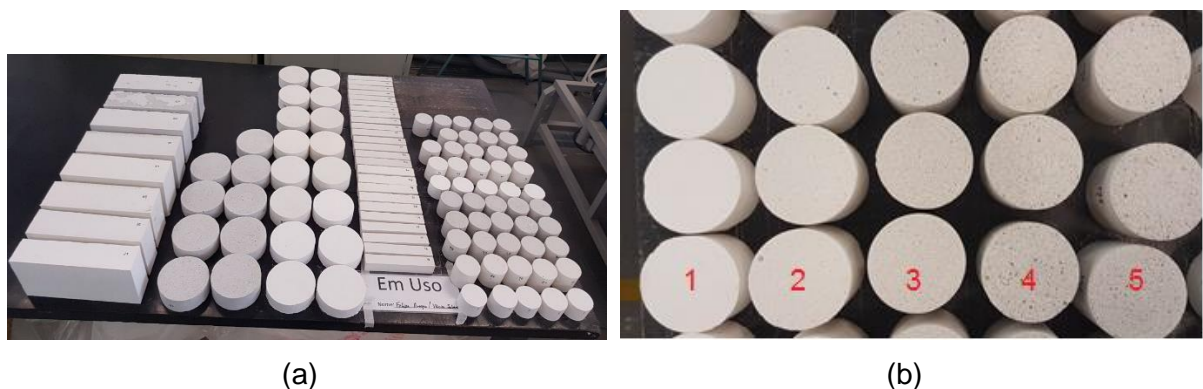
Figura 68: Corpos de prova produzidos (a) e diferença de cor entre eles (b).
