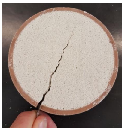
Figura 47: Trinca no molde com travamento inadequado.
