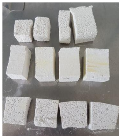
Figura 64: Amostras para ensaio de porosidade (Método de Arquimedes).
