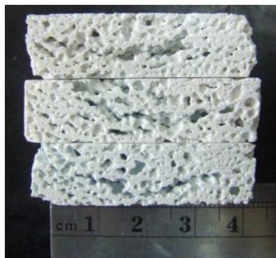
Figura 31: Poros para composição com 3% \text{NaHCO}_3 como agente espumante.
