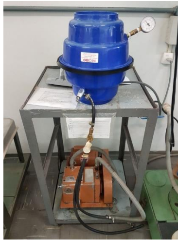
Figura 65: Ensaio para obtenção da porosidade - Método de Arquimedes.
