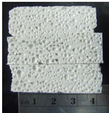
Figura 30: Poros para composição de 2.5% de Al_2(SO_4)_3 e 0,70% ácido cítrico.
