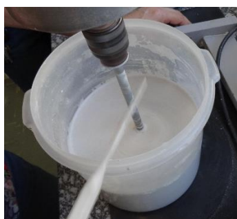
Figura 45: Espuma de gesso pronta para moldar.
