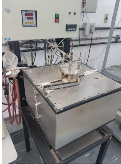
Figura 63: Equipamento do ensaio de condutividade térmica.
