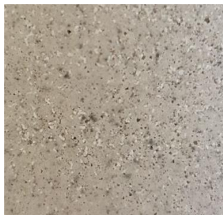
Figura 69: Não homogeneização da composição com 3,5% de micro sílica.
