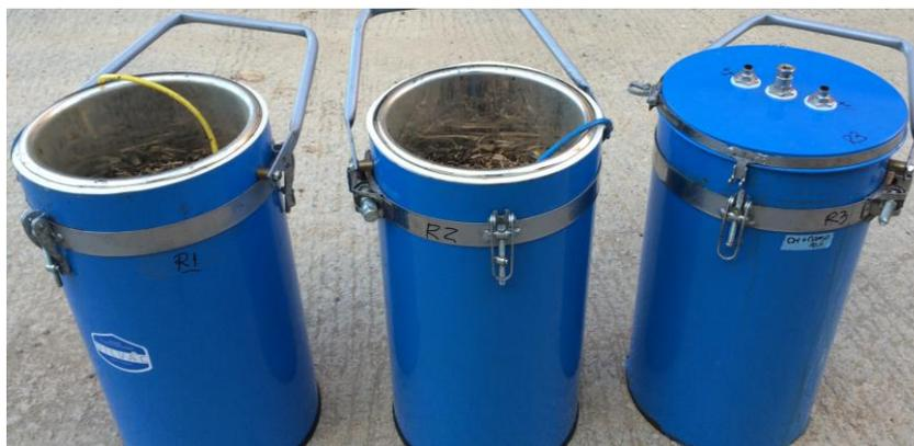
**Figura 5.28** – Reatores após 14 dias de experimento (final do experimento) – Biossecagem I, Biossecagem II e Controle (da esquerda para direita).
