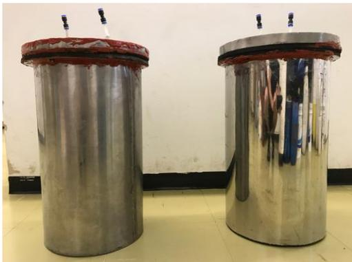
**Figura 4.18** – Reatores semi-herméticos utilizados nos experimentos de biossecagem no Brasil.
