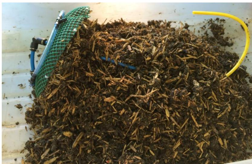
**Figura 5.27** – Realização de revolvimento nos reatores denominados Biossecagem.
