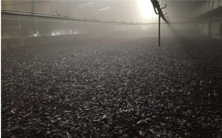
**Figura 5.17** – Leito biológico utilizado para tratamento do ar de saída dos reatores.
