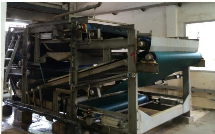
**Figura 5.3** – Vista lateral de um dos filtros prensa de correia da ETE de Manresa.
