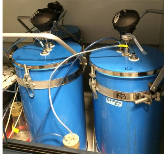
**Figura 4.2** – Reatores semi-herméticos de 10L de capacidade, utilizados no experimento de biossecagem, equipados com sensor de temperatura, e mangueiras de entrada e saída de ar.
