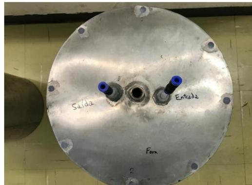
**Figura 4.19** – Tampa do reator de biossecagem ilustrando canais de entrada e saída de ar e local para sensor de temperatura.
