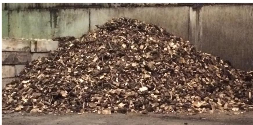
**Figura 5.13** – Material estruturante (madeira triturada) utilizado na mistura.
