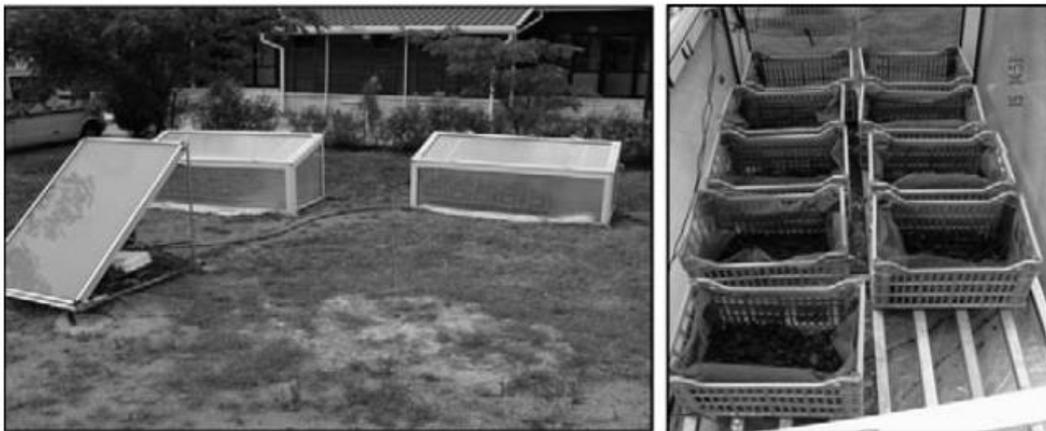
**Figura 3.11** – Protótipos de leitos solares (esquerda) e vista interior do leito (direita).
