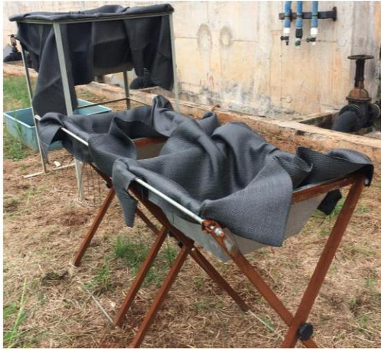
**Figura 4.10** – Três protótipos de leito de drenagem em escala piloto alocados ao lado do reator UASB, para estudo da evaporação (um com capacidade volumétrica de 260L e dois com 50L).
