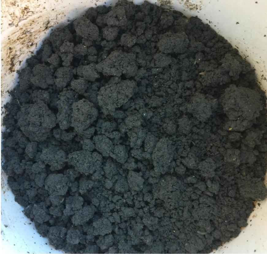
**Figura 4.7** – Lodo de esgoto misturado (anaeróbio, anóxico e aeróbio) e desaguado em centrífuga, da ETE Bèsos, Barcelona, Espanha.
