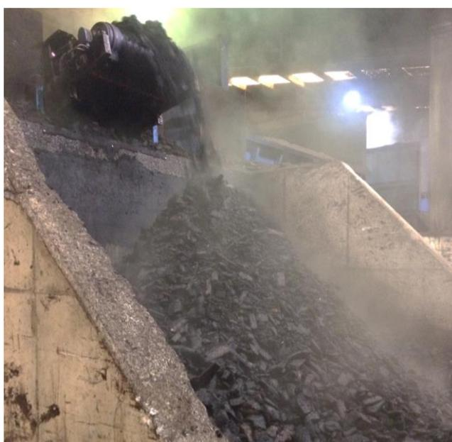
**Figura 5.14** – Material (lodo "biosseco") retido na peneira de 12mm utilizado em nova mistura, retornando ao início do processo.
