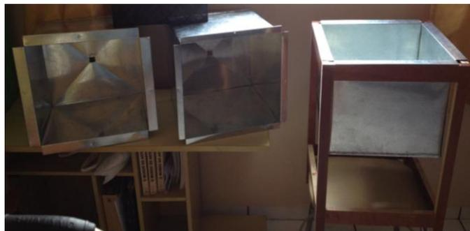
**Figura 4.13** – Protótipos de leito de drenagem em escala laboratorial, para estudo da drenagem das mantas (com capacidade volumétrica de 25L).
