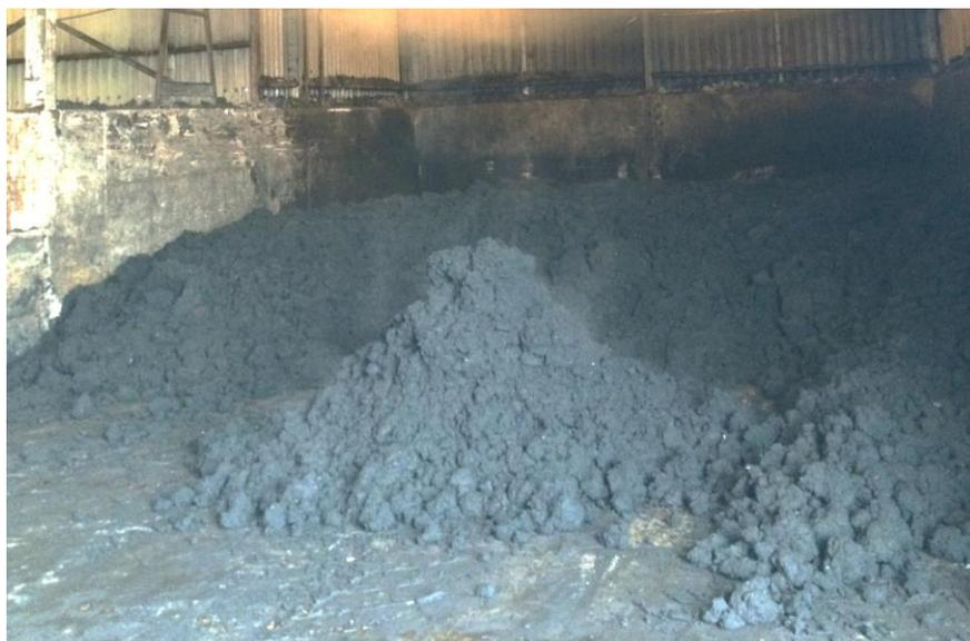
**Figura 5.12** – Aspecto do lodo desaguado em centrífuga.
