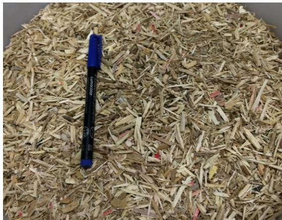
**Figura 4.8** – Madeira triturada e peneirada utilizada como material estruturante ( $\leq 7,10\text{mm}$ ).
