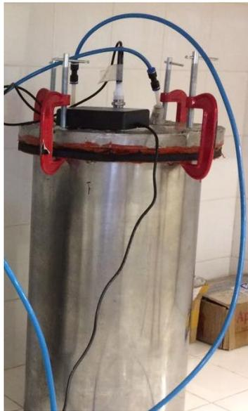
**Figura 4.17** – Reator semi-hermético com sensor de temperatura ao centro e mangueiras de entrada e saída de ar.
