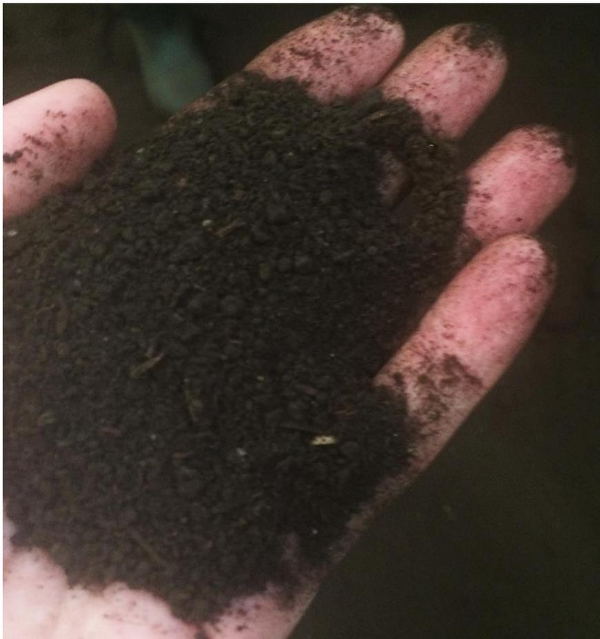
**Figura 5.19** – Lodo biosseco, chamado biogranulado, após o processo completo de biossecagem.
