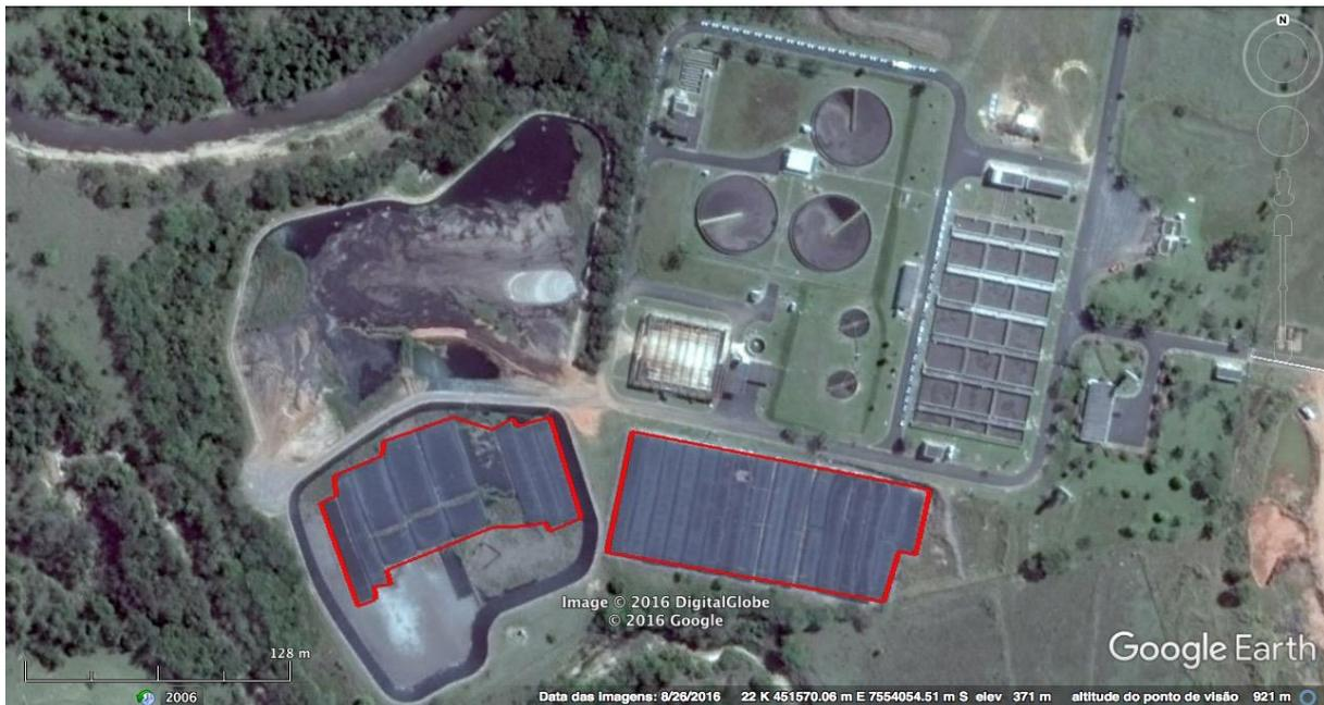
**Figura 3.15** – ETE Limoeiro (Presidente Prudente-SP), com destaque (vermelho) para a extensa área ocupada pelos bags utilizados para desaguamento do lodo. Imagem de 26/08/2016.
