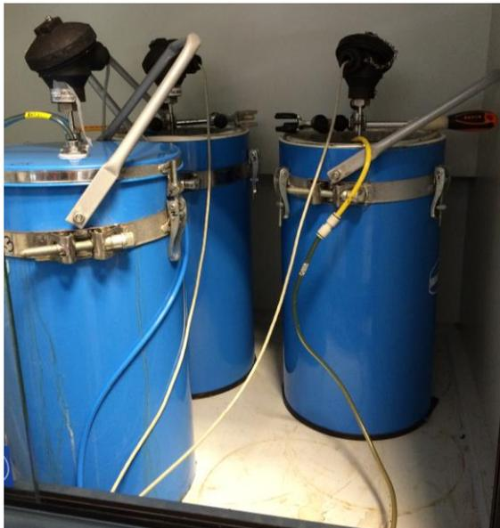
**Figura 4.3** – Reatores semi-herméticos de 10L de capacidade, um de controle (fechado) e dois de biossecagem (abertos após o terceiro dia).
