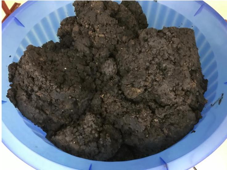
**Figura 4.22** – Lodo anaeróbico previamente desaguado em leito de drenagem (sistema natural).
