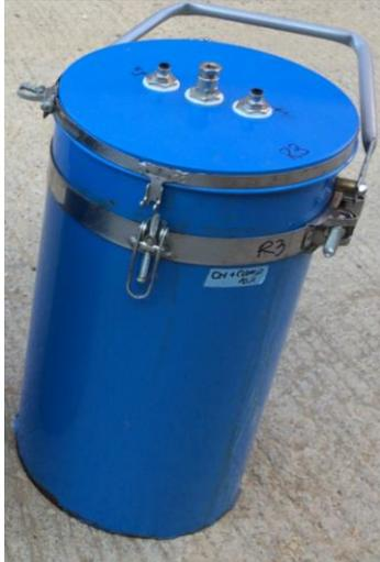
**Figura 4.1** – Reator semi-hermético de 10L de capacidade, utilizado no experimento de biossecagem.
