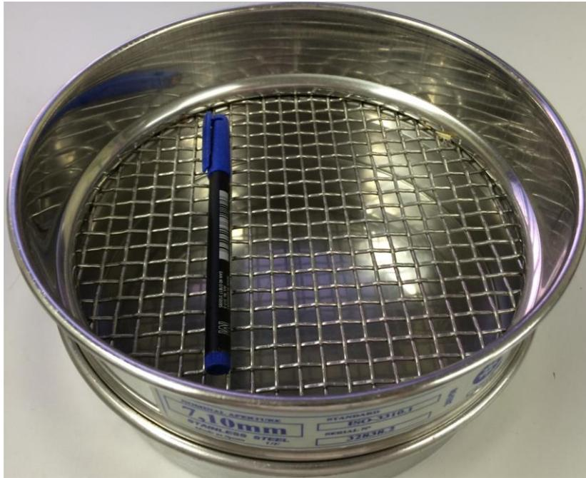
**Figura 4.9** – Peneira utilizada para peneirar a madeira de *pallets* triturada, com abertura de 7,10mm.
