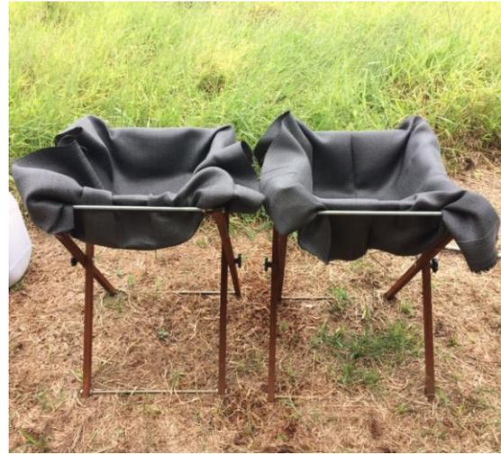
**Figura 4.11** – Protótipos de leito de drenagem em escala piloto (menores).
