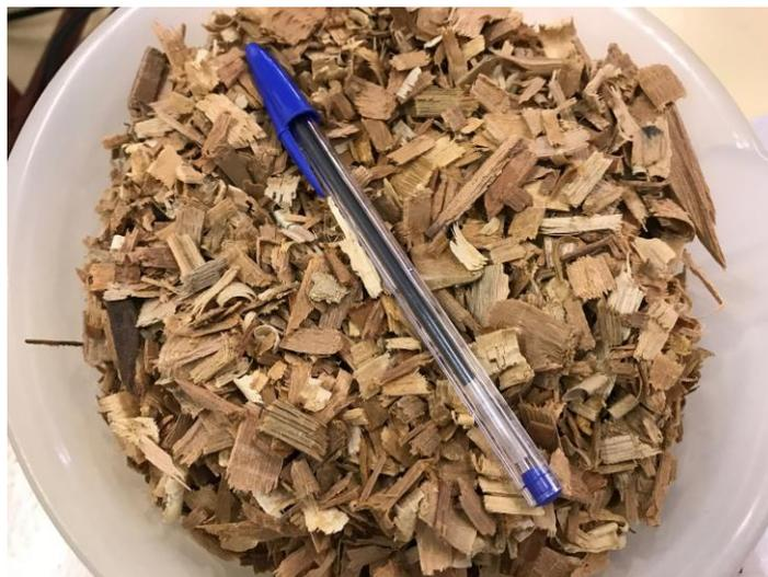
**Figura 4.23** – Material estruturante (cavaco de madeira) com dimensões entre 5 e 15mm.
