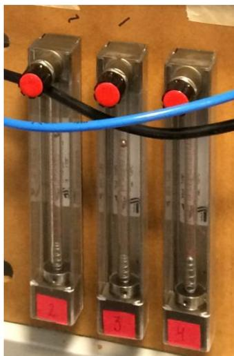
**Figura 4.6** – Rotômetros utilizados para controle da vazão de ar (fixo) após atingir a máxima temperatura (apenas dois em utilização).
