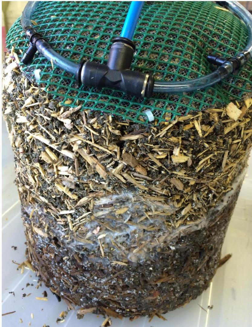
**Figura 5.32** – Estratificação de secagem no reator Controle (fundo do reator acima e topo abaixo).
