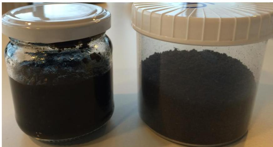
**Figura 5.20** – Apecto do lodo afluyente (lodo “bruto”, à esquerda) e efluente (lodo biosseco ou biogranulado, à direita) ao processo de biossecagem.
