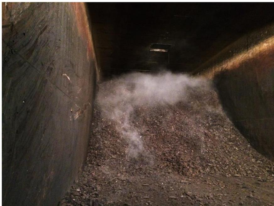
**Figura 5.16** – Interior de um reator após aberto, em processo de remoção da massa para submeter à peneira rotativa.
