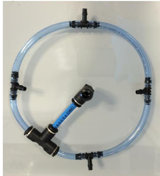
**Figura 4.4** – Aparato de mangueira com quatro pontos de entrada de ar alocado ao fundo do reator, melhorando a distribuição ao longo da massa, do fundo para o topo.
