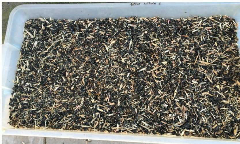
**Figura 5.26** – Mistura do lodo com estruturante (proporção volumétrica 2:1).
