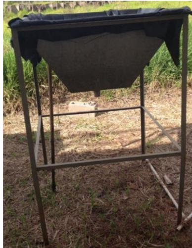
**Figura 4.12** – Protótipo de leito de drenagem em escala piloto (maior).
