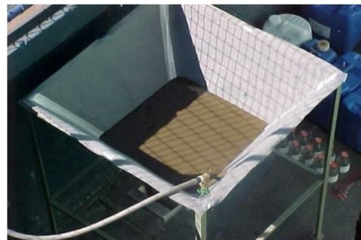
**Figura 3.29** – Protótipo leito de drenagem.
