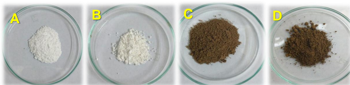
FIGURA 4.6 - Diferenças observadas na textura do pó obtido após a secagem em Spray Dryer . Sendo representadas as micropartículas de (A) gelatina, (B) gelatina e aerosil, (C) lignina e (D) lignina e aerosil.
