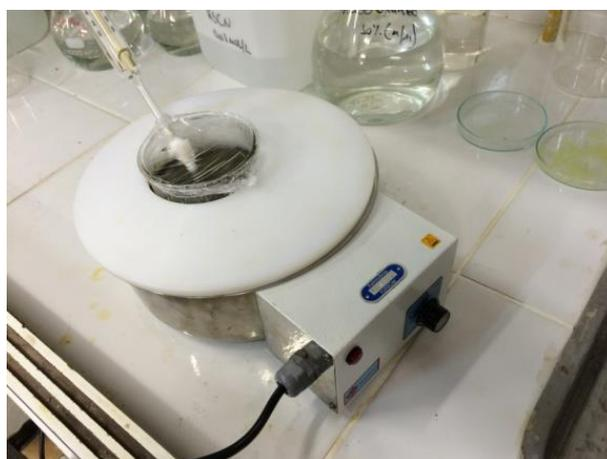
Figura 4.10 - Ensaio de imersão em solução de NaCl + H<sub>2</sub>O<sub>2</sub> a 30°C conforme norma ASTM G110.
