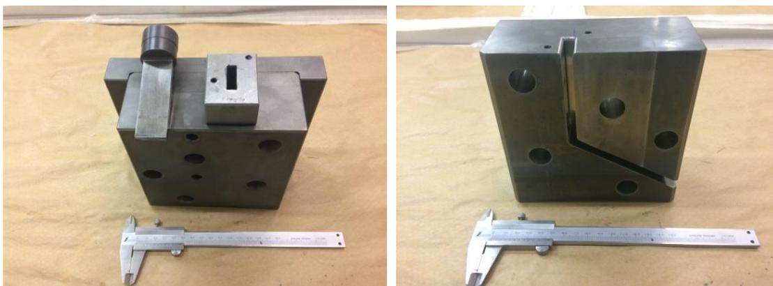
Figura 4.4 - Matriz ECAP utilizada para processamento das amostras.
