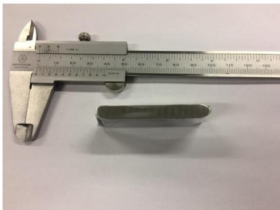
Figura 4.8 - Corpo de prova do ECAP utilizado para medição de microdureza Vickers na superfície Y.
