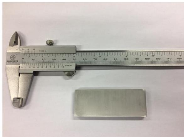
Figura 4.3 - Corpo de prova final para processamento no ECAP.
