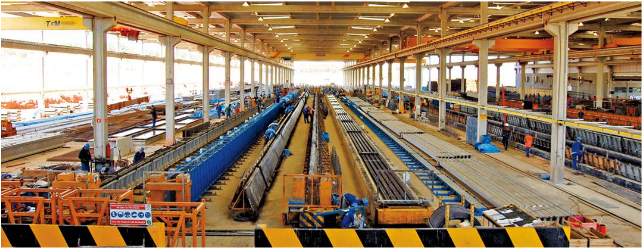
Figura 2-10 - Visão de uma pista de fabricação de elementos em fábrica
