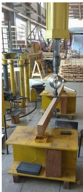
Figura 3: Ensaio de Flexão Estática em Peças Estruturais.
