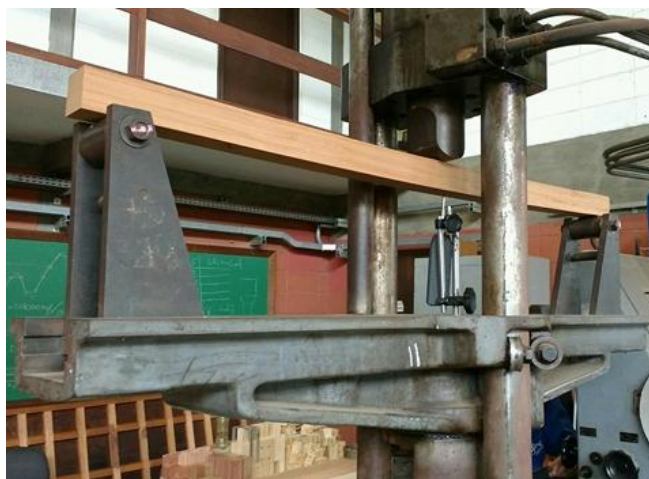
Figura 2: Ensaio de Flexão Estática em Corpos de Prova normatizados.
