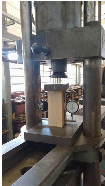
Figura 5: Ensaio de Compressão Paralela às fibras em Peças Estruturais.
