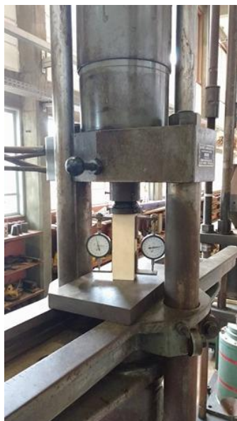
Figura 4: Ensaio de Compressão Paralela às fibras em Corpos de Prova normatizados.
