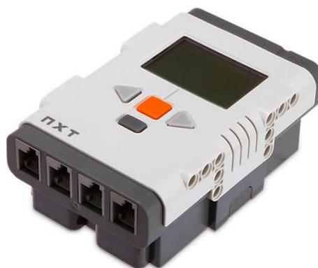
**Figura 5.14.** Unidade de controle Lego *Mindstorms* NXT
