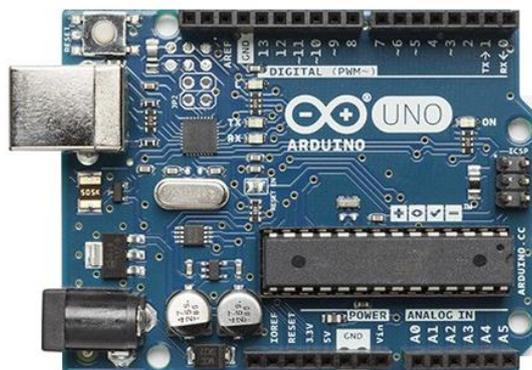
**Figura 5.1.** Placa de prototipagem Arduino UNO
