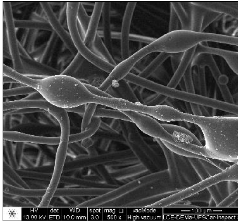
Figura 38-Fotografia tirada pelo MEV para o filtro de carvão ativado
