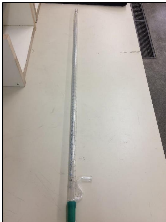
Figura 31- Ebuliômetro para a amostragem isocinética
