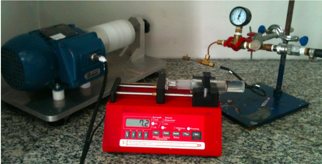
FIGURA 4.1 - Imagem do sistema de fiação por sopro em solução
