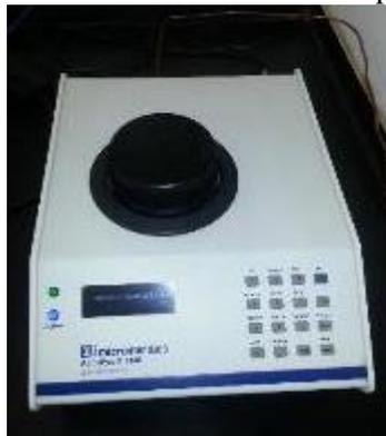
A massa específica é uma relação entre a massa e volume de sólidos das partículas (excluindo-se os poros permeáveis). O ensaio de picnometria de hélio consiste em medir a mudança de pressão ocorrida em uma célula sem a presença de partículas de sólido e uma célula com a presença de partículas de sólido. O volume de sólidos é calculado pela equação abaixo:
