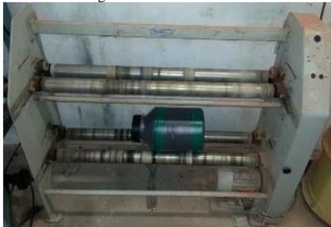
Para realizar a moagem da ACBC, foi utilizado um vasilhame de polietileno com volume de 10 litros (Figura 19 (a)), 5 litros de corpos moedores (10,5kg) e 2,5 litros de ACBC (3kg). Foram utilizadas bolas de alumina (Figura 19 (b)) com os seguintes diâmetros: 20 mm (154 unidades), 30 mm (46 unidades), 40 mm (18 unidades) e 50 mm (4 unidades).
