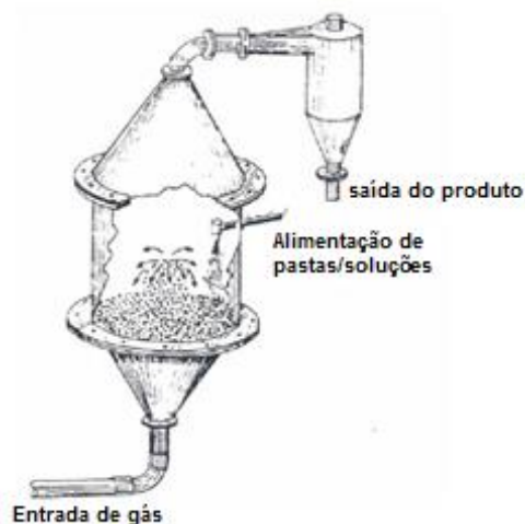
Figura 1.1 – Secagem de pasta em leito de jorro com ciclone.
