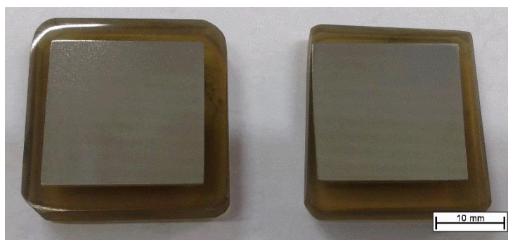
Figura 4.7 Corpo de prova (liga AA5754) utilizado para a realização do ensaio de corrosão intergranular.
