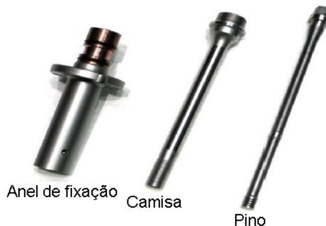
Figura 3.5 Ferramentas utilizadas na soldagem FSpW [2].
