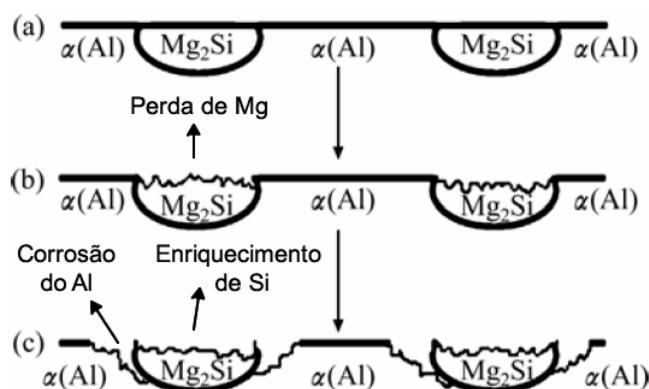
Figura 3.18 Esquema do mecanismo de corrosão nas partículas de Mg_2Si [54].
