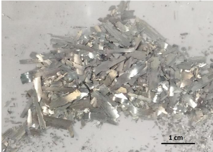
Figura 3.1 - Amostra de fita metálica produzida por melt-spinning.
