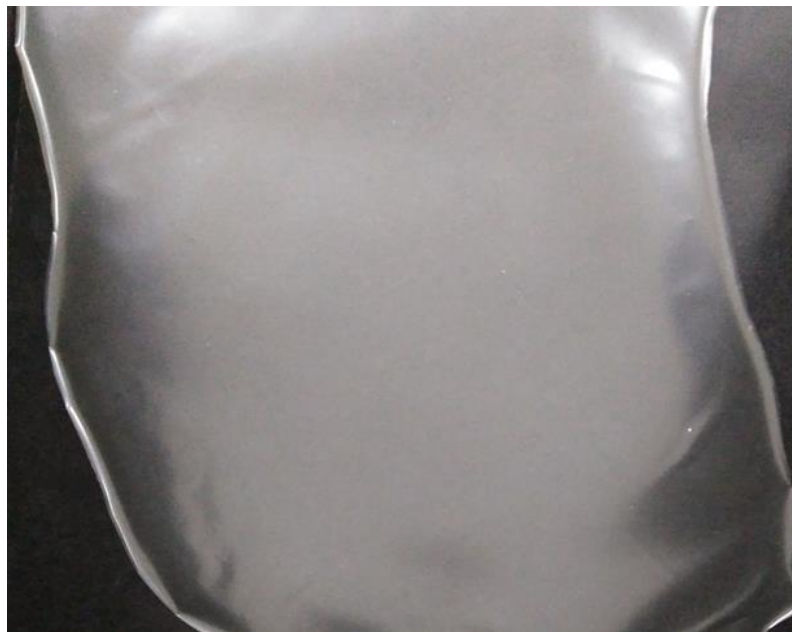
FIGURA 4.1: Filme seco de PEC 2 % produzido por casting (descontínuo).
