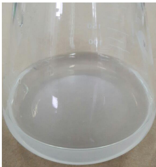
FIGURA 4.1: Suspensão coloidal de nanopartículas de quitosana.
