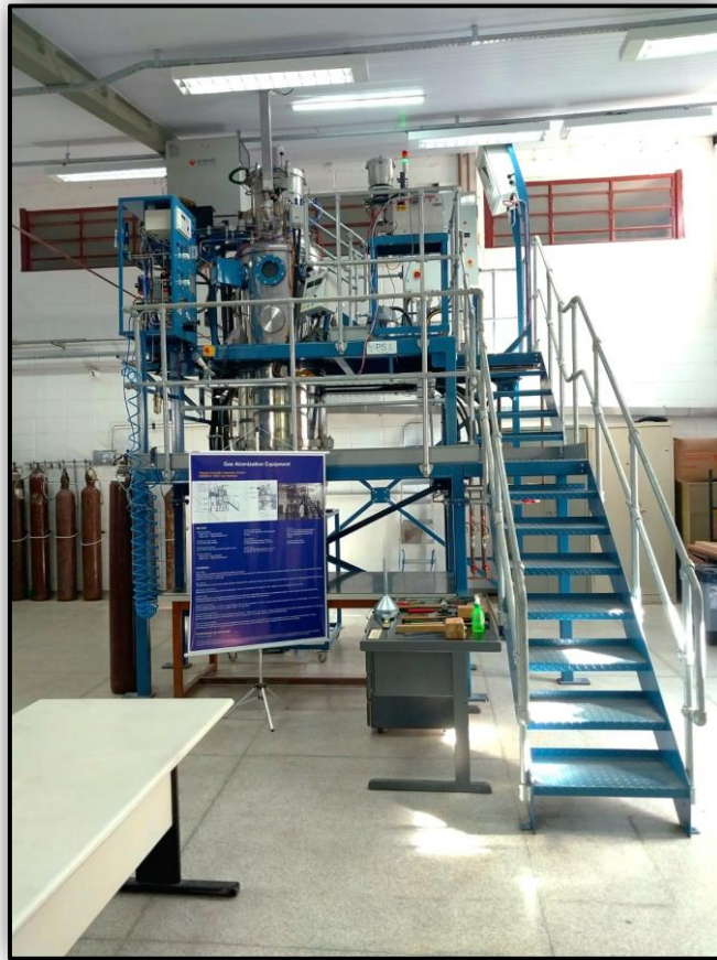
Figura 3.5 - Atomizador a gás (Gas Atomiser HERMIGA 75/5VI (EAC) - PSI-Phoenix Scientific Industries Ltd) disponibilizado no DEMa/UFSCar.
