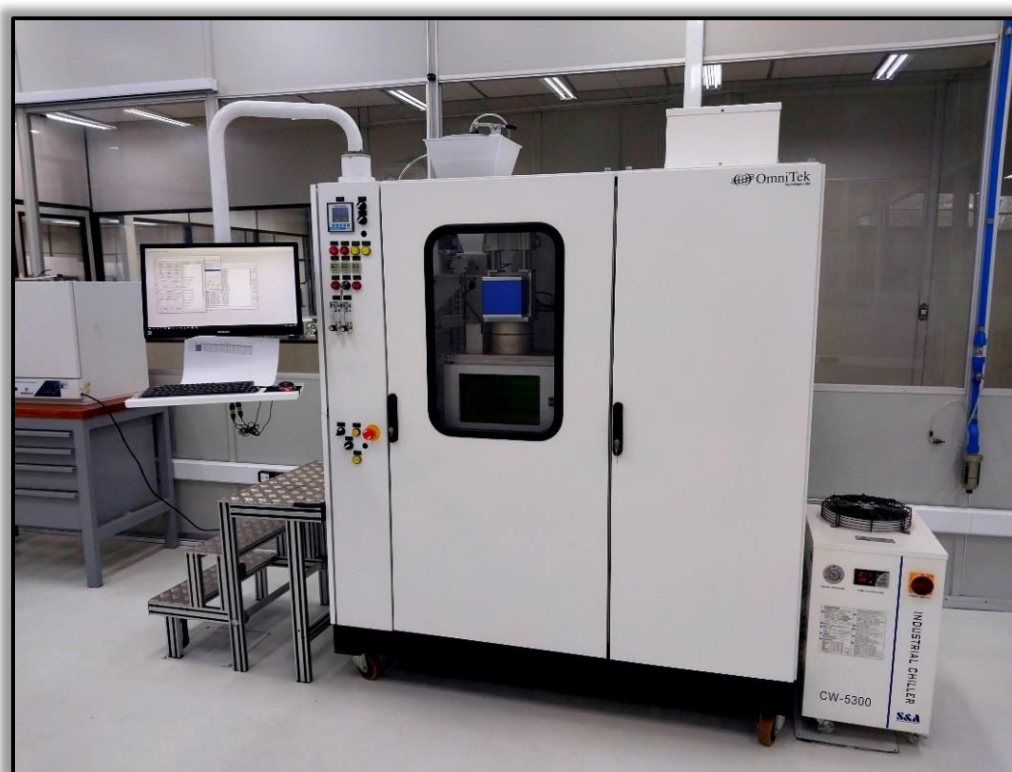
Figura 3.7 - Máquina utilizada para impressão das amostras (OMNITEK – OminiSint) – ISI SENAI Santo Amaro (SP).
