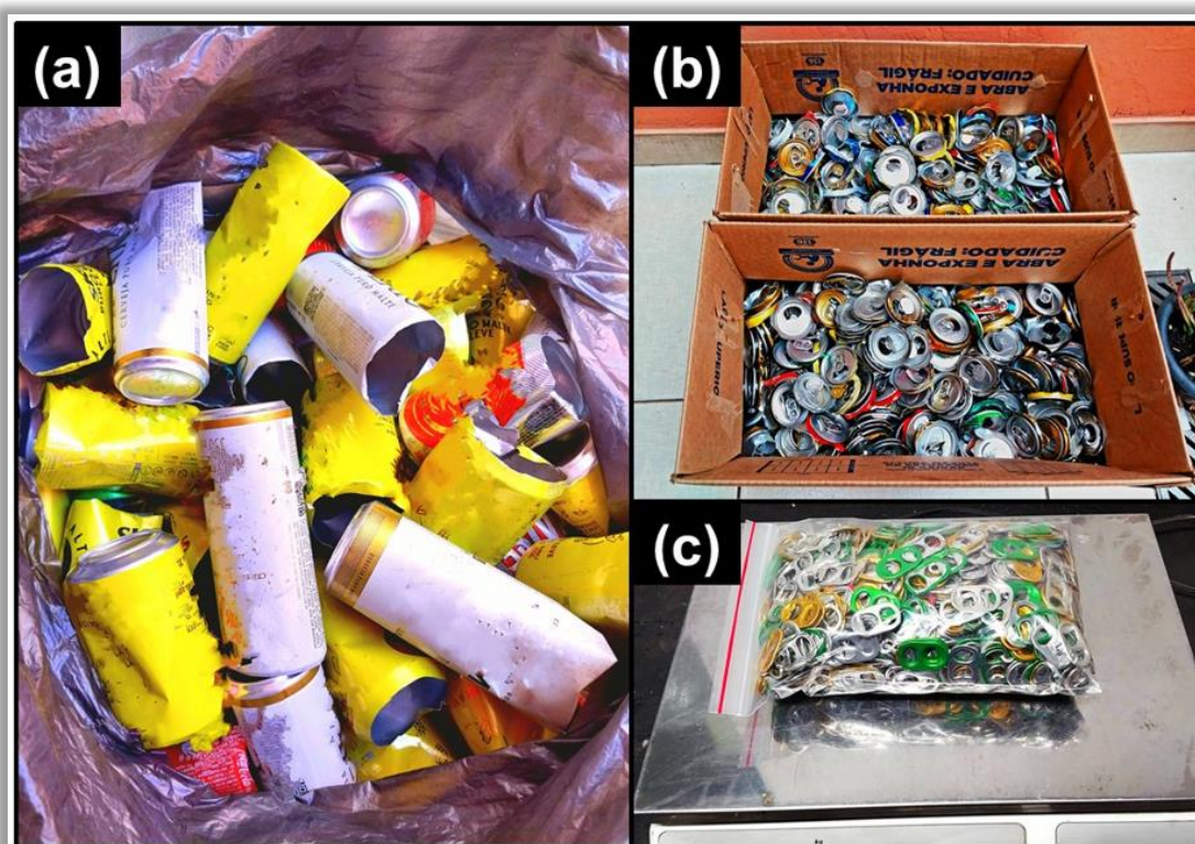
Figura 3.2 - Procedimento para obtenção da liga mãe à base de latas de alumínio recicladas: a) Latas de alumínio recicladas após a remoção das tampas; b) Tampas separadas das latas de alumínio; c) Separação dos lacres das tampas.
