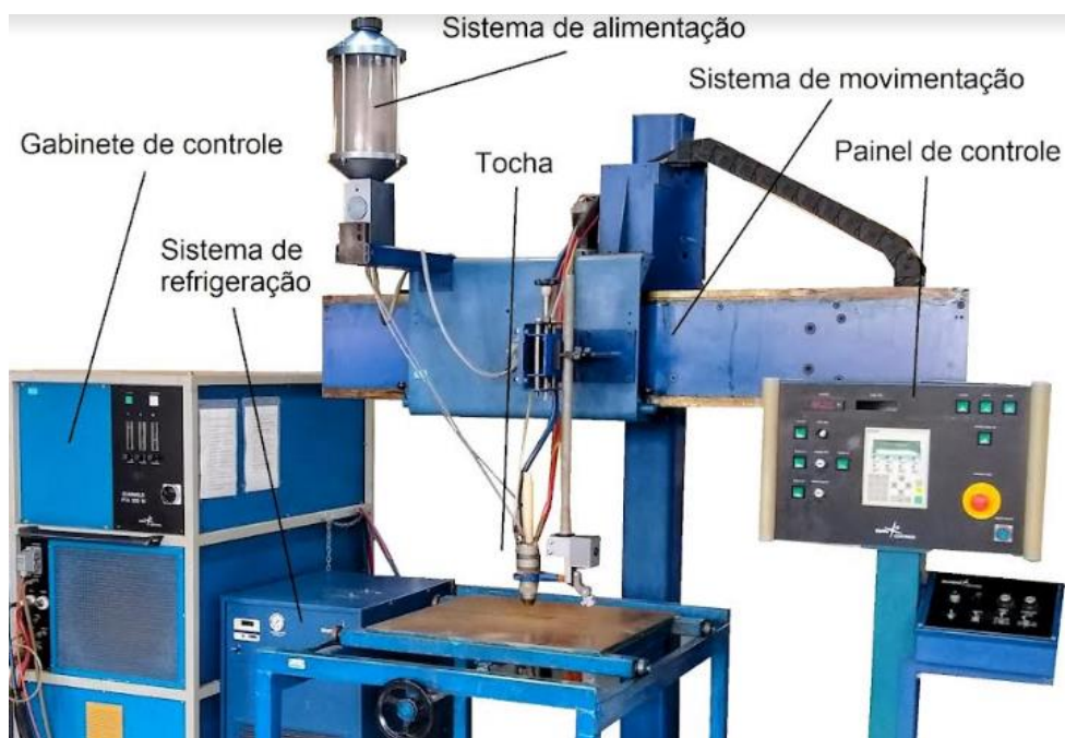
Figura 2.21: Foto do sistema de processamento para deposição por PTA. (Cortesia: professora Ana Sofia C. M. D’Oliveira).
