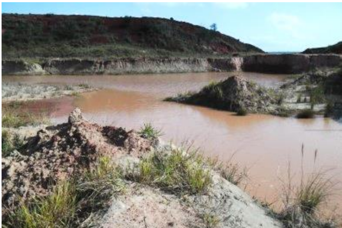
Figura 46. Barreiro desativado não recuperado no Bairro Queimador e formação de lago de águas pluviais em 2014.
