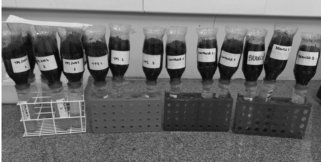
Figura 6: Sistema para determinação da retenção de água no solo e de lixiviação.
