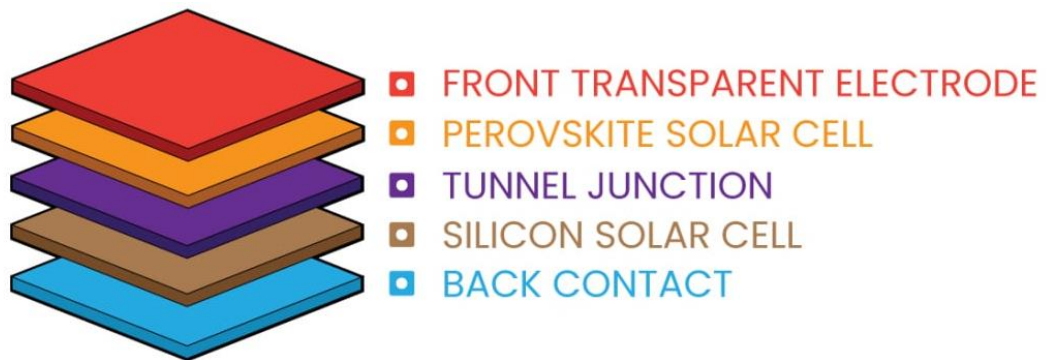
Figura 14 – Estrutura esquemática de uma célula tandem perovskita/silício. Fonte: [44].
