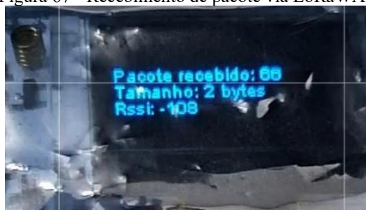
Figura 67 - Recebimento de pacote via LoRaWAN
