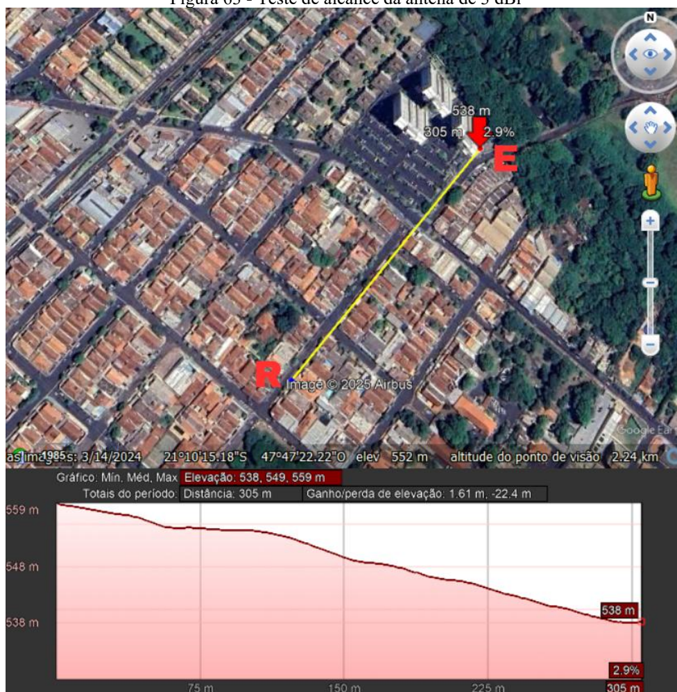
Figura 63 - Teste de alcance da antena de 3 dBi
