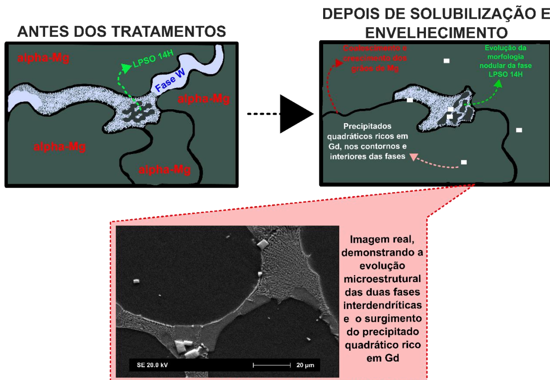
Figura 23 - Representação da evolução da liga Mg-10Gd-1Eu-1Zn-0,2Zr após o tratamento térmico T6.
