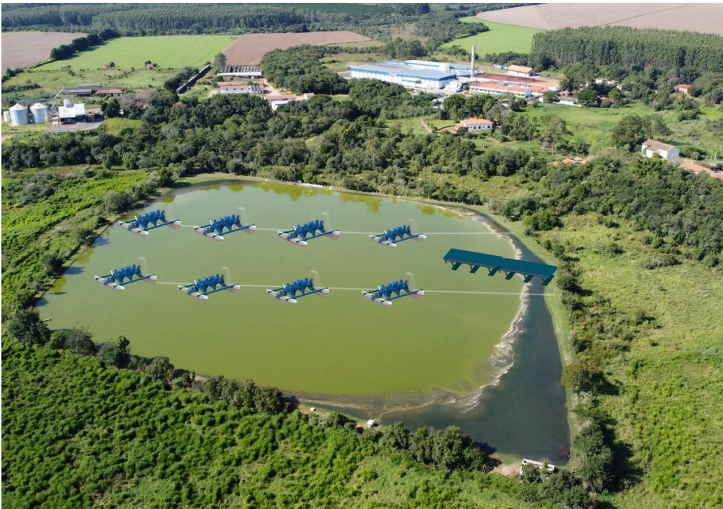
Figura 4 – Ilustração da distribuição dos aeradores de pás alternadas na lagoa facultativa
