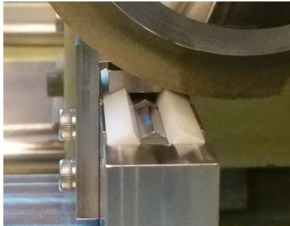
Figura 7: Aparato necessário para realizar o entalhe no corpo de prova cerâmico.
