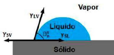
Figura 2.2 – Representação das interfaces e tensões interfaciais originadas da deposição da gota de um líquido sobre uma superfície sólida de acordo com o modelo de Young (Fonte: Adaptado de [19]).
