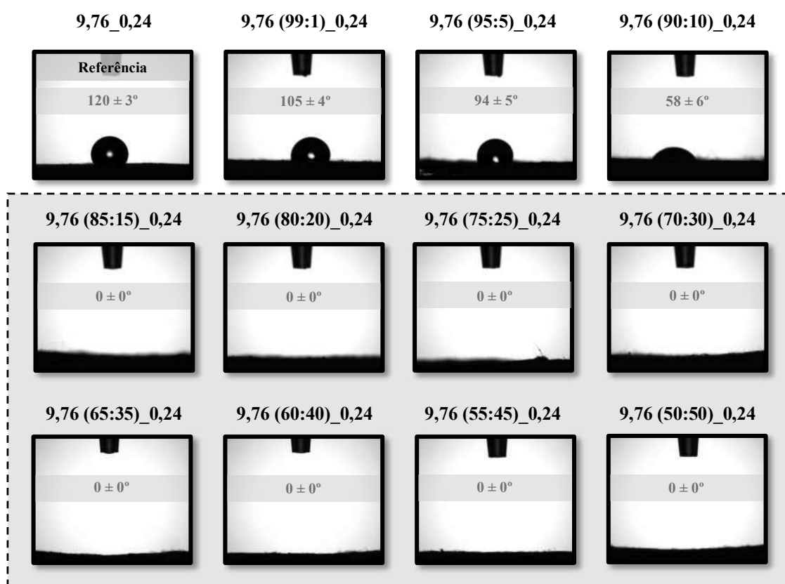
Figura 4.35 – Ângulo de contato estático de nanofibras baseadas em acetato de celulose/PEO contendo teores de PEG entre 1 e 50% m/m para um período de 5 s após a deposição da gota de água deionizada.
