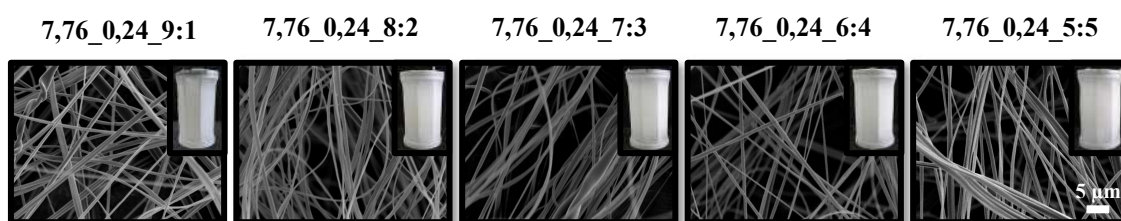
Figura 4.23 – Micrografias de nanofibras de acetato de celulose/PEO obtidas a partir de soluções utilizando os ácidos fórmico e acético (2:1 v/v) em combinação com diferentes proporções volumétricas de DCM no sistema de solventes (aumento de 3.000 x).
