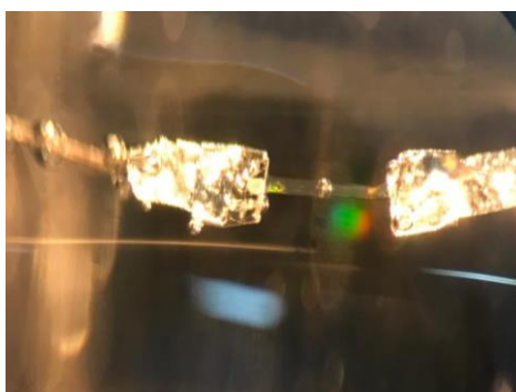
Figura 10 - Filamento único de fibra muscular no equipamento Aurora
