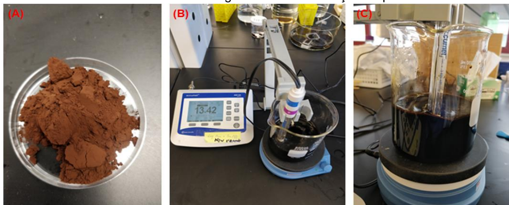
Figura 6. Processo de fracionamento da lignina Kraft via variação do pH.
