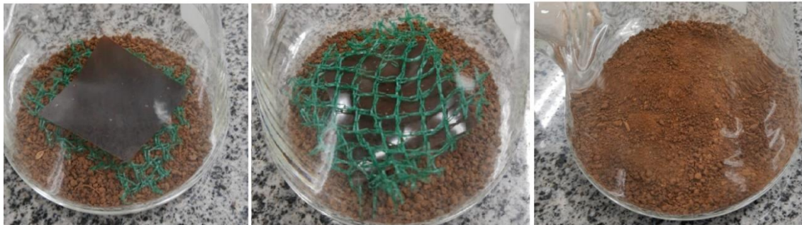
Figura 17. Incubação do filme AM/LK75 no respirômetro de Bartha para biodegradação.
