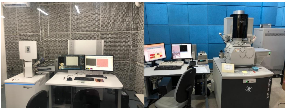
Figura 3.2.3.1.1: Ao lado esquerdo, equipamento TESCAN MIRA utilizado para obtenção de resultados de EDS. Ao lado direito, equipamento Magellan 400 L utilizado para obtenção de resultados de MEV.
