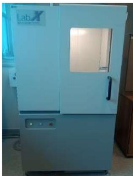
Figura 3.2.3.3.1: Equipamento de GIXRD utilizado para a obtenção das estruturas cristalinas e fases dos recobrimentos. [16]
