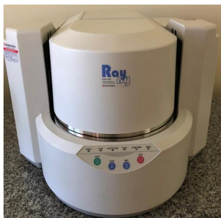
Figura 3.2.3.2.1: Equipamento de XRF utilizado para a análise qualitativa dos elementos químicos presentes nos recobrimentos.
