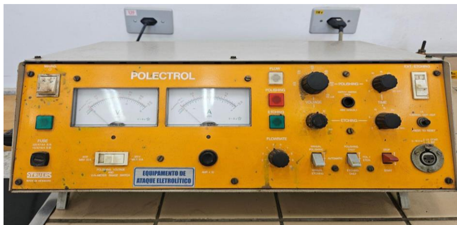
Figura 13. Equipamento utilizado para ataque eletrolítico das amostras analisadas.
