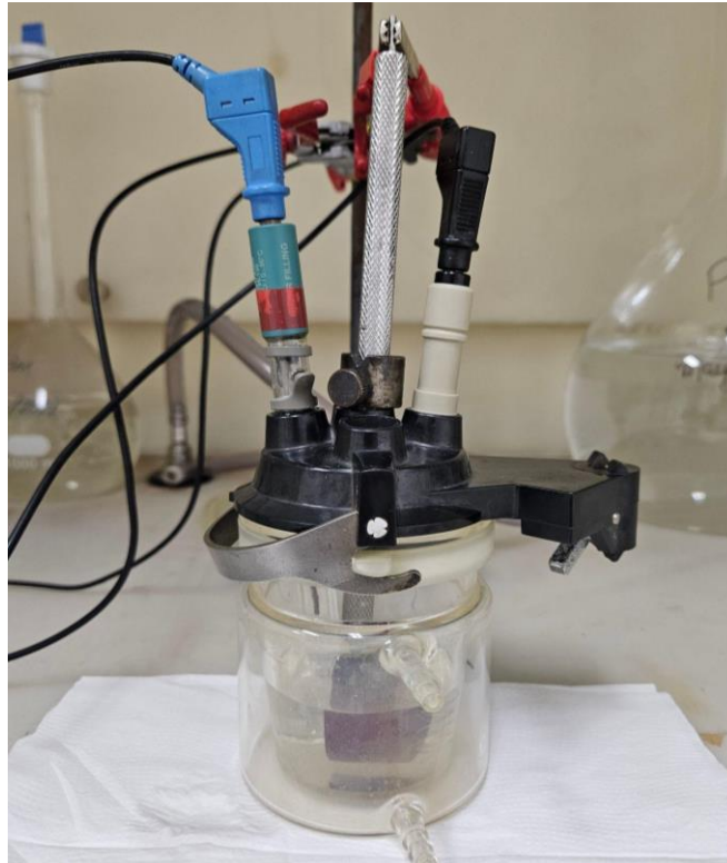
Figura 15. Célula de polarização montada para o ensaio de polarização potenciodinâmica.
