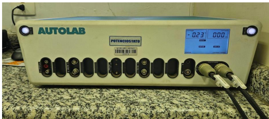
Figura 14. Potenciostato utilizado para o ensaio de polarização potenciodinâmica.
