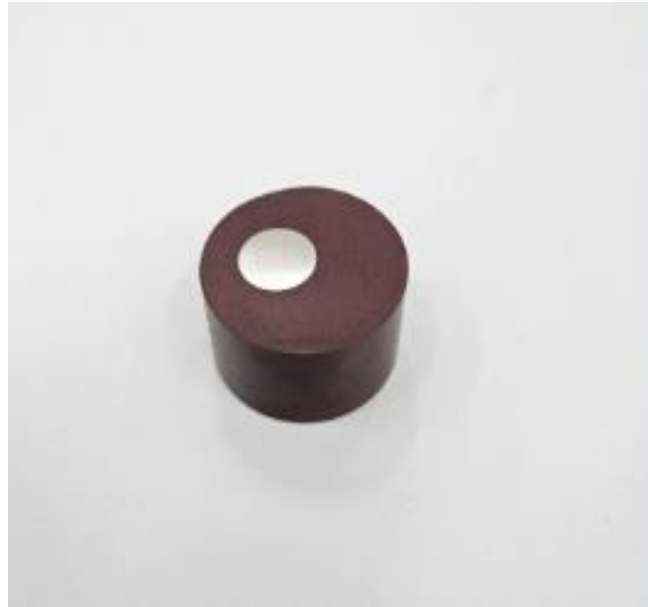
Figura 11. Amostra do aço ASTM F138 após embutimento e lixamento.
