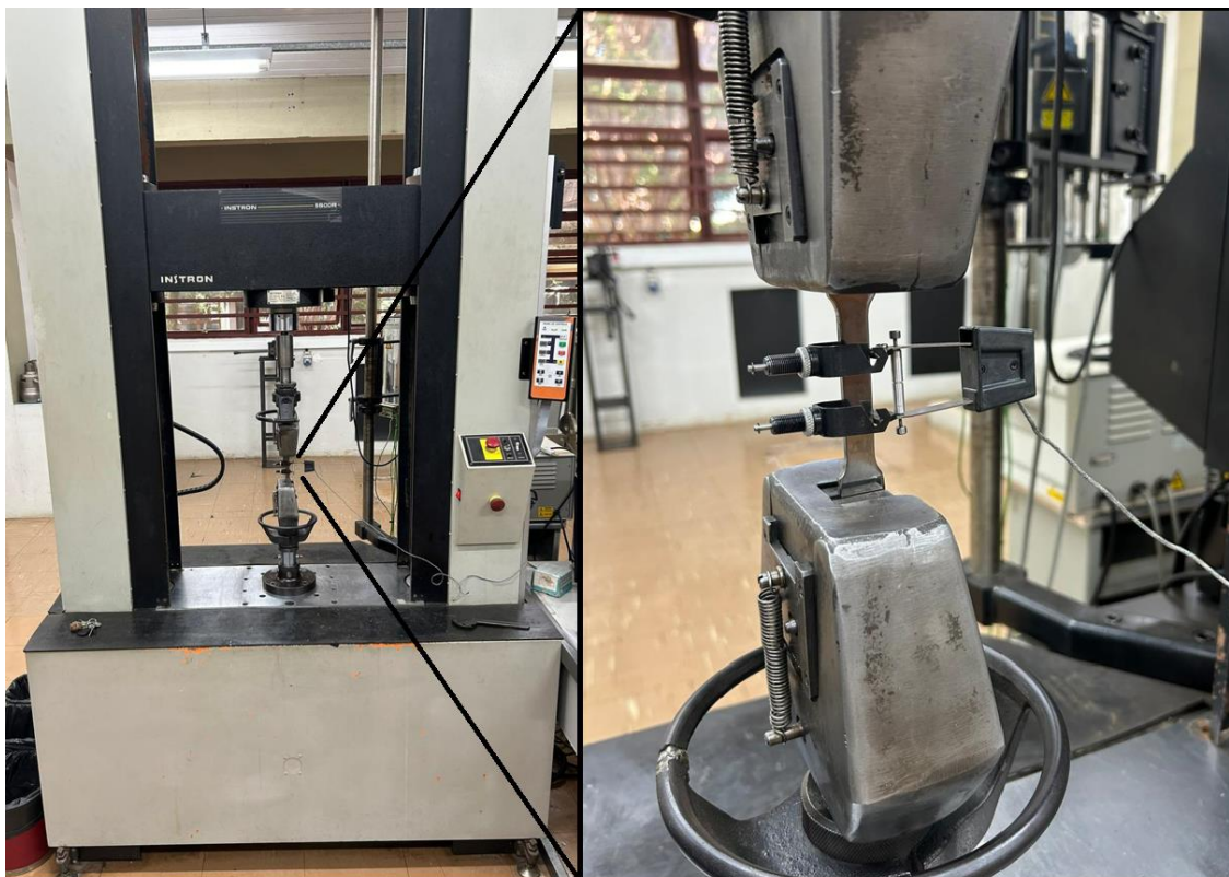
Figura 3.11: Ensaio de tração para caracterização na máquina Instron modelo 5585H
