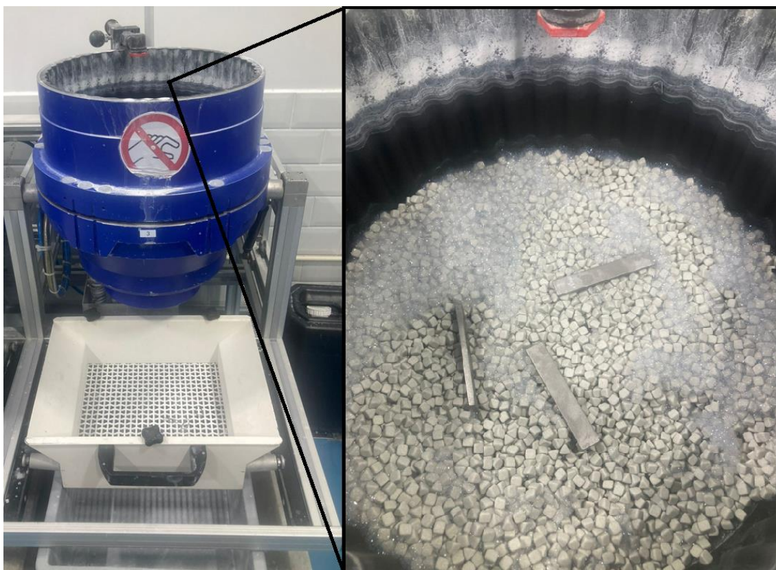
Figura 3.5: Polimento mecânico das amostras no tamboreador rotativo
