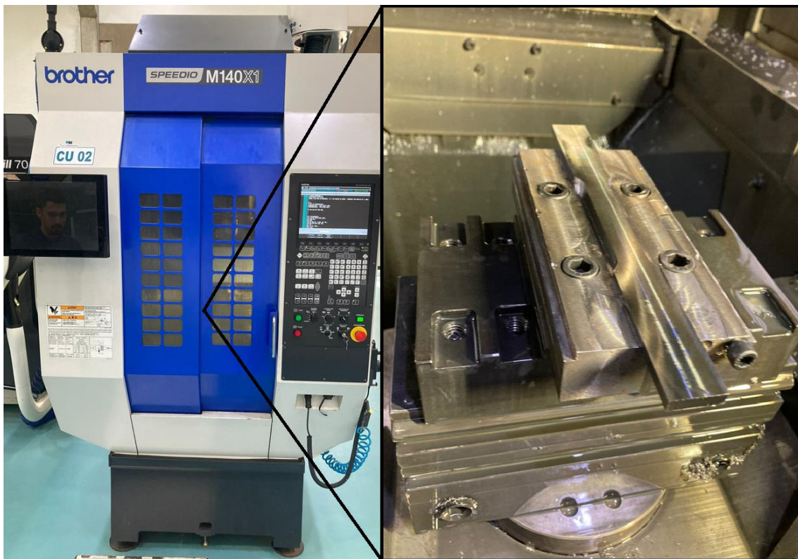
Figura 3.2: Usinagem dos corpos de prova no equipamento CNC.
