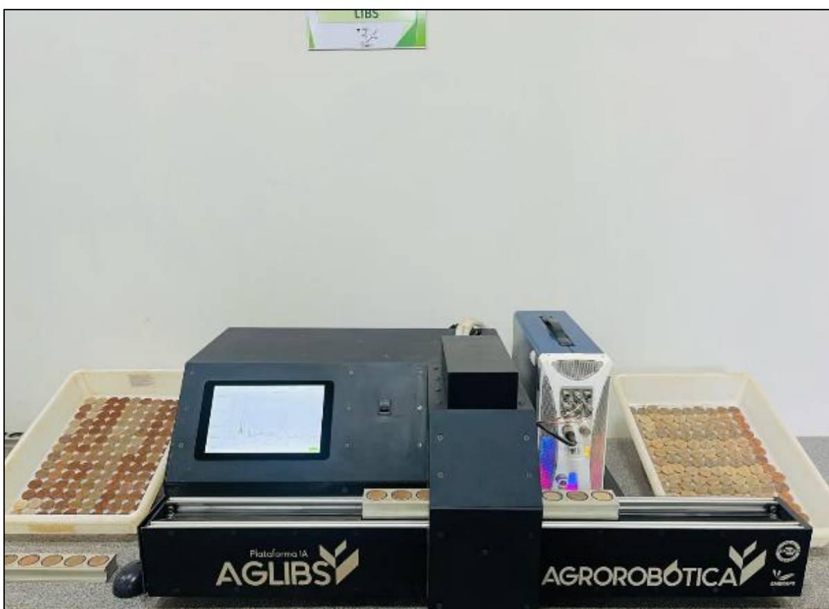
Figura 12. AGLIBS - equipamento utilizado para as análises de solo.
