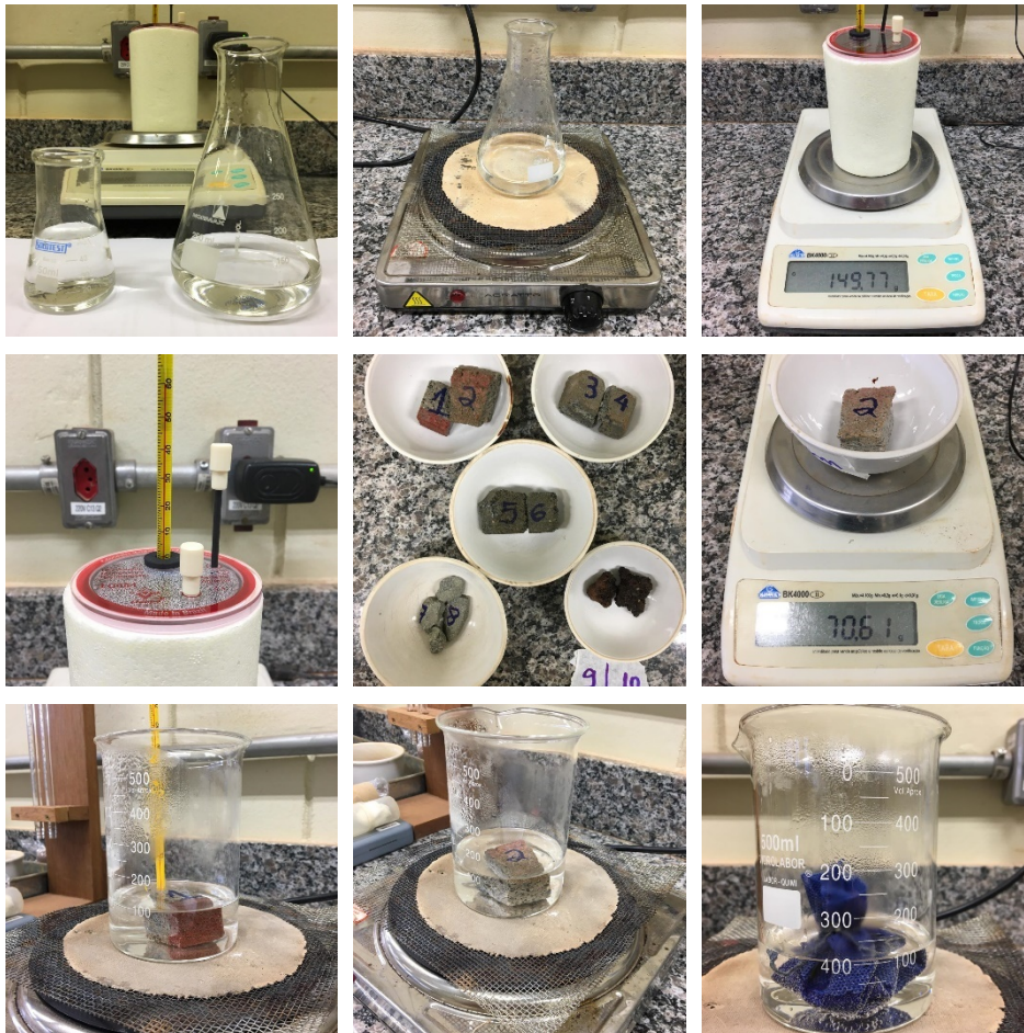
Figura 1. Ensaio para determinação do calor específico dos materiais, utilizando um calorímetro.
