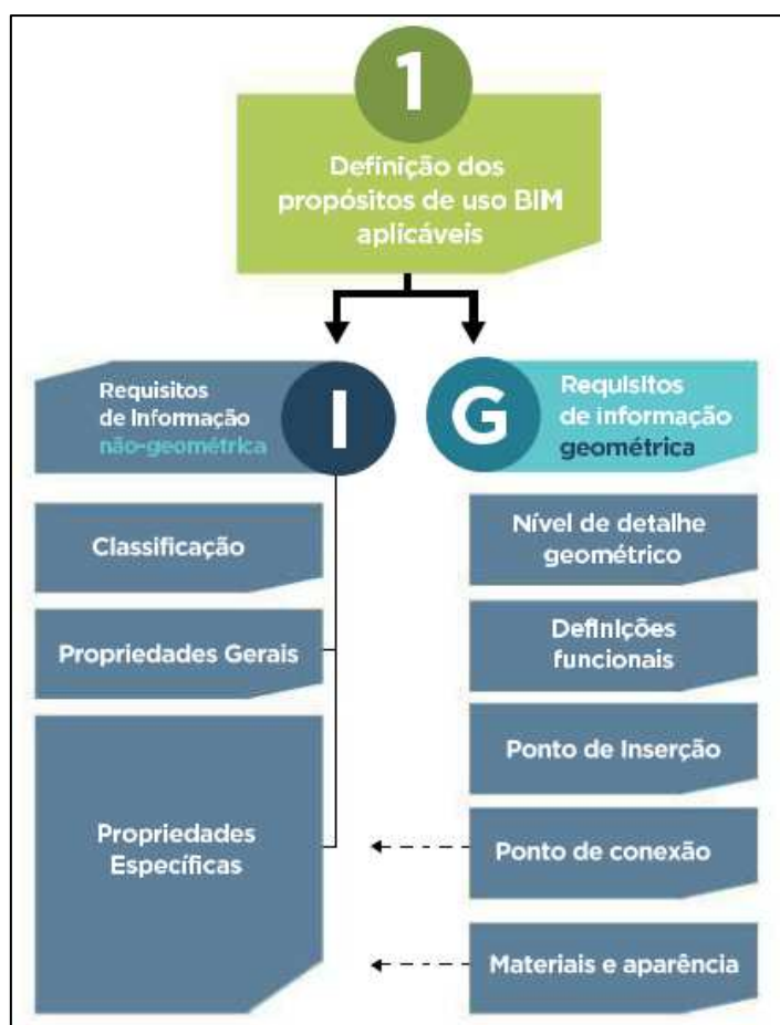
Figura 38: etapas para a especificação de objetos BIM. Fonte: BFB (2024b).
