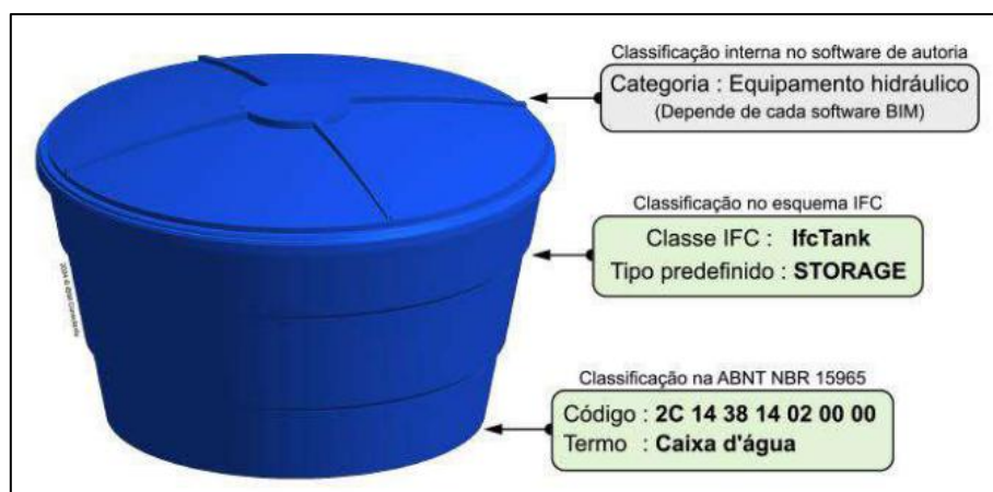
Figura 39: exemplos de classificação de um objeto BIM. Fonte: BFB (2024b).
