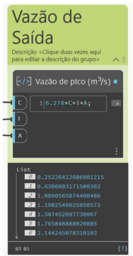
Figura 81: Algoritmo Dynamo para vazão máxima de bacia, parte 6. Fonte: Elaborada pelo Autor.
