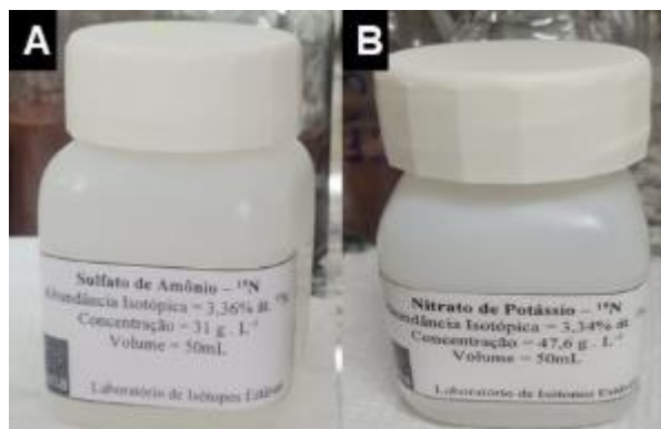
Figura 4 – Soluções de sulfato de amônio [ (^{15}\text{NH}_4)_2\text{SO}_4 ] (a) e nitrato de potássio ( \text{K}^{15}\text{NO}_3 ) (b) aplicadas nas unidades experimentais.
