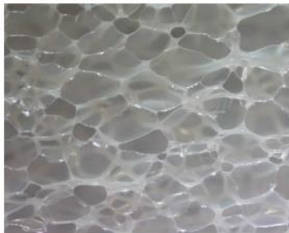
Figura 17- Espuma de PVC de célula fechada [19].
