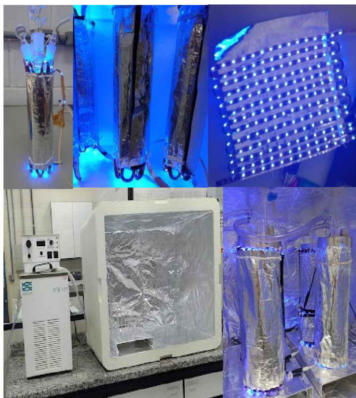
Figura 6.2: Fotobiorreator para o cultivo em meio líquido.
