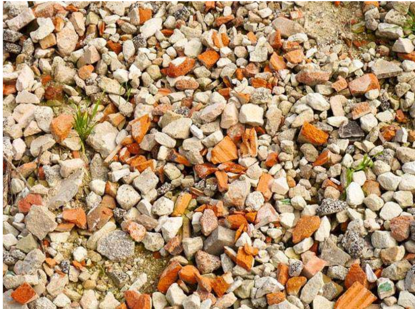
Figura 3 - Exemplos de resíduos de Classe A (fragmentos de telhas, blocos cerâmicos e restos de concreto)
