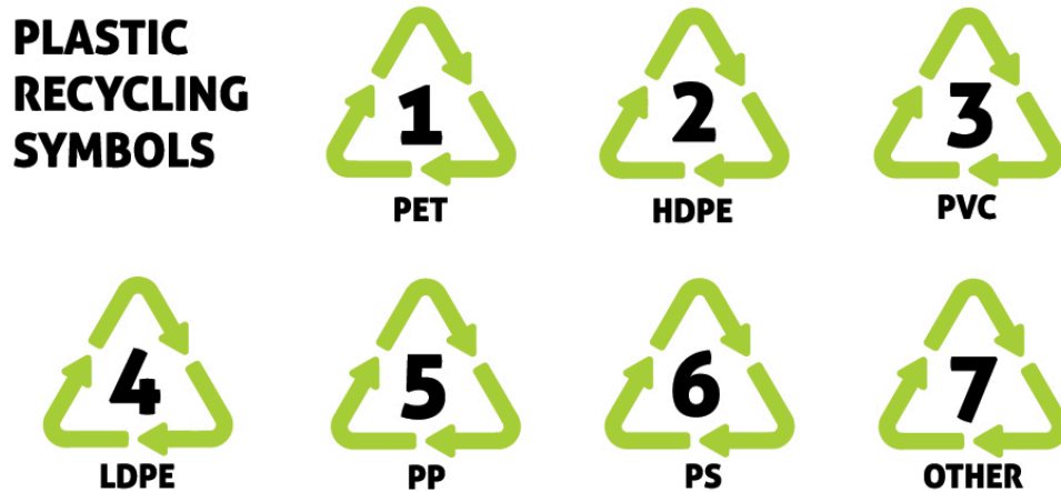
Figura 4. Códigos de identificação de resinas ( Resin Identification Codes - RIC ) conforme ASTM D7611/D7611M-21 (Fonte adaptada: 2EA).
