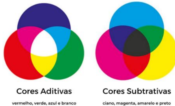
Figura 4. Diagrama da combinação das cores primárias e secundárias em sistemas aditivos e subtrativos.
