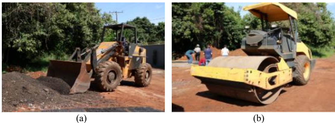
Figura 3.16 – Máquinas utilizadas: (a) Pá carregadeira; (b) Rolo liso vibratório.
