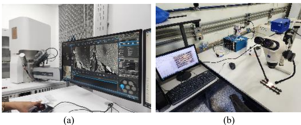
Figura 3.21 – Equipamentos usados para ensaio de MEV e microscopia digital: (a) MEV; (b) Microscopia digital.
