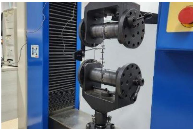
Figura 3.7 – Equipamento do ensaio de resistência à tração de geogrelhas do Laboratório de Geotecnia da UFSCar.
