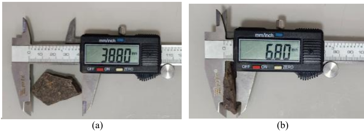
Figura 3.19 – Ensaio de índice de forma: (a) comprimento; (b) espessura.
