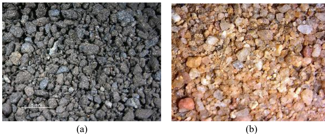
Figura 3.20 – Agregado natural e fresado passantes na peneira #4: (a) RAP; (b) Areia.
