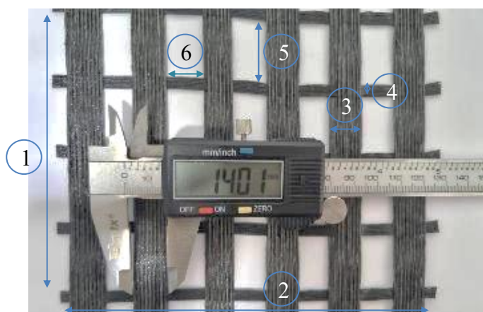
Figura 3.2 – Características físicas das geogrelhas.
