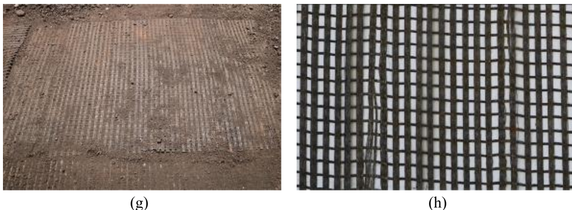
Figura 4.4 – Geogrelhas sentido transversal – fresado: (a) GG1; (b) Registro do estado da Geogrelha; (c) GG2; (d) Registro do estado da Geogrelha; (e) GG3; (f) Registro do estado da Geogrelha; (g) GG4; (h) Registro do estado da Geogrelha.
