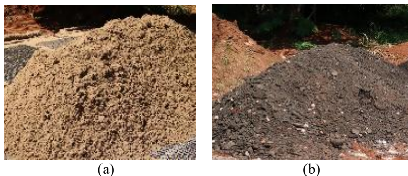
Figura 3.3 – Agregado natural e fresado: (a) areia; (b) RAP.
