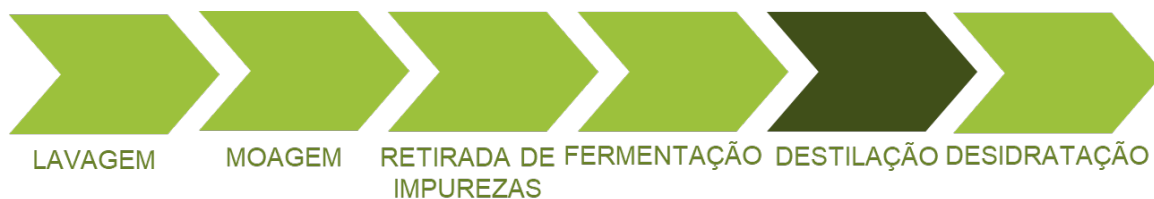
Figura 3. 8 - Etapas de produção de E1G (adaptado de Nova Cana, [S.d.])
