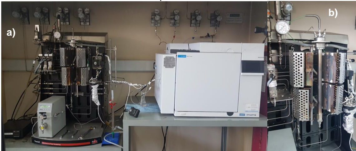
Figura 7 - a) Linha de alta pressão FlowCAT da empresa HEL acoplado ao cromatógrafo gasoso da Agilent. b) Reator de aço inoxidável na linha de alta pressão.
