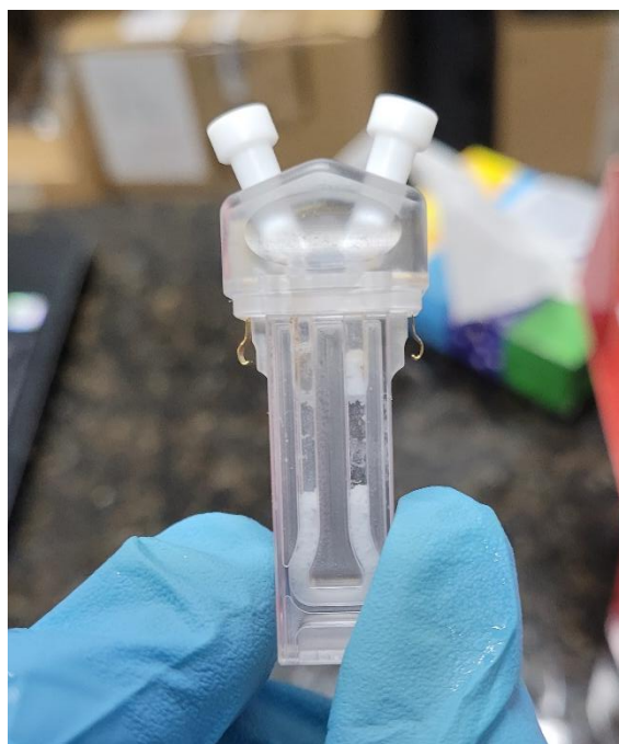
Figura 4.47 – Sedimentação da suspensão de 2,5%p de BioS e 2,5%p de PVA, após a medição a análise do potencial zeta.
