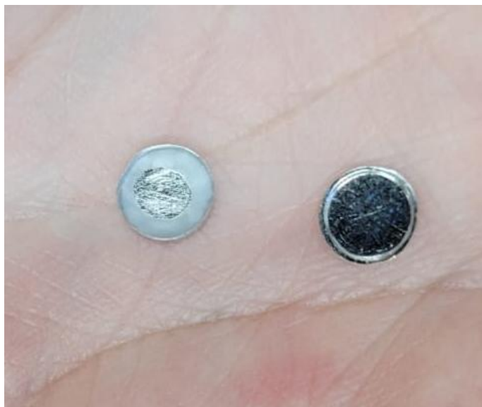
Figura 3.4 – Cadinho contendo amostra de BioS (após o ensaio), utilizado no ensaio de calorimetria diferencial de varredura.
