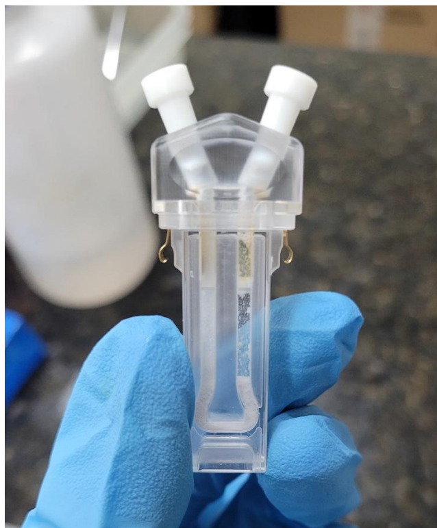
Figura 4.46 – Sedimentação da suspensão de 2,5%p de BioS com 0,5%p de PVA após a medição a análise do potencial zeta.
