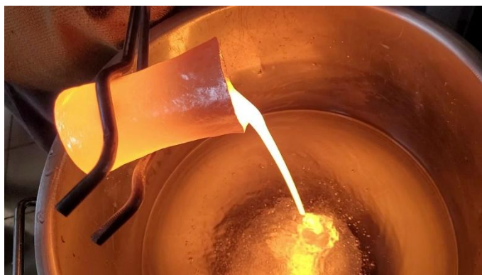
Figura 3.2 – Procedimento de obtenção de frita de BioS.
