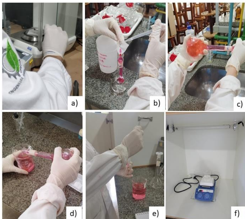
Figura 8 Procedimento experimental de preparo das soluções padrão de Eritrosina B em solução tampão fosfato 0,2 mol/L: a) pesagem do corante; b) transferência do corante para o balão e adição de tampão fosfato; c) homogeneização da solução; d) transferência da solução para o béquer; e) medida da absorbância em t_0 ; f) inserção do béquer no fotoreator.
