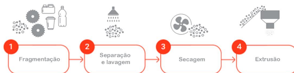
Figura 2.6 - Fluxograma com as principais etapas da reciclagem mecânica de polímeros (adaptado de [4]).
