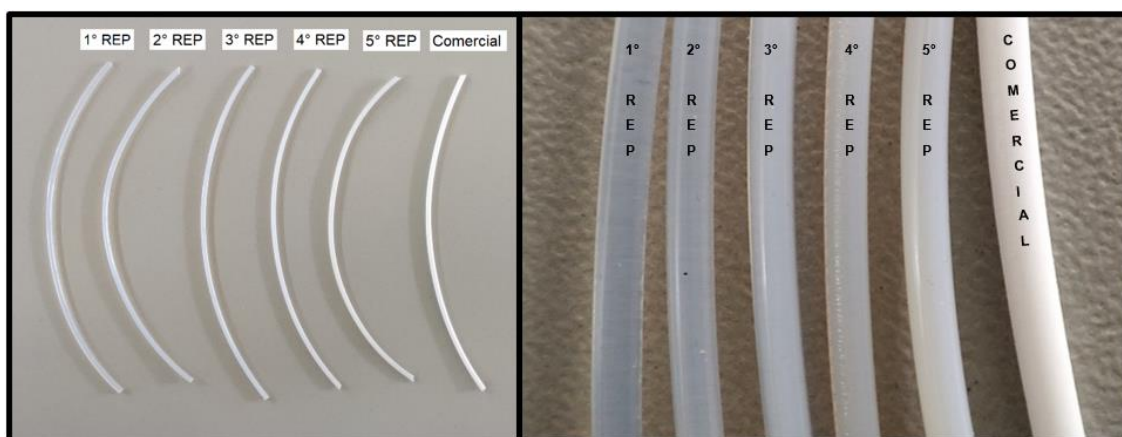
Figura 3.17 - Imagens dos filamentos de PETG pós-processo obtidos nos 5 ciclos de processamento e do filamento de PETG comercial.
