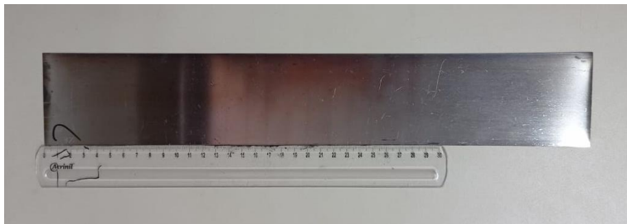
Figura 4. 4 - Chapa de 8 %m. Cr após os tratamentos termomecânicos, ela apresentou dimensões de 43,3 x 7,1 mm e 0,6 mm de espessura.
