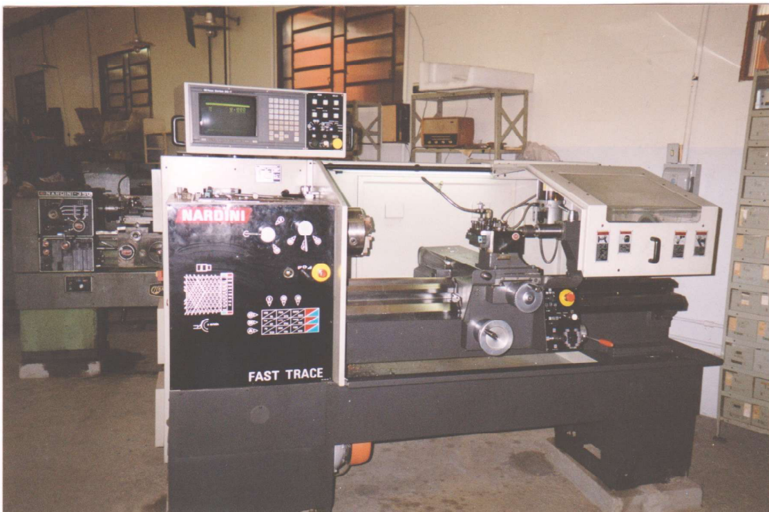
Figura 13: Usinagem dos corpos de prova por processo de Torno.
