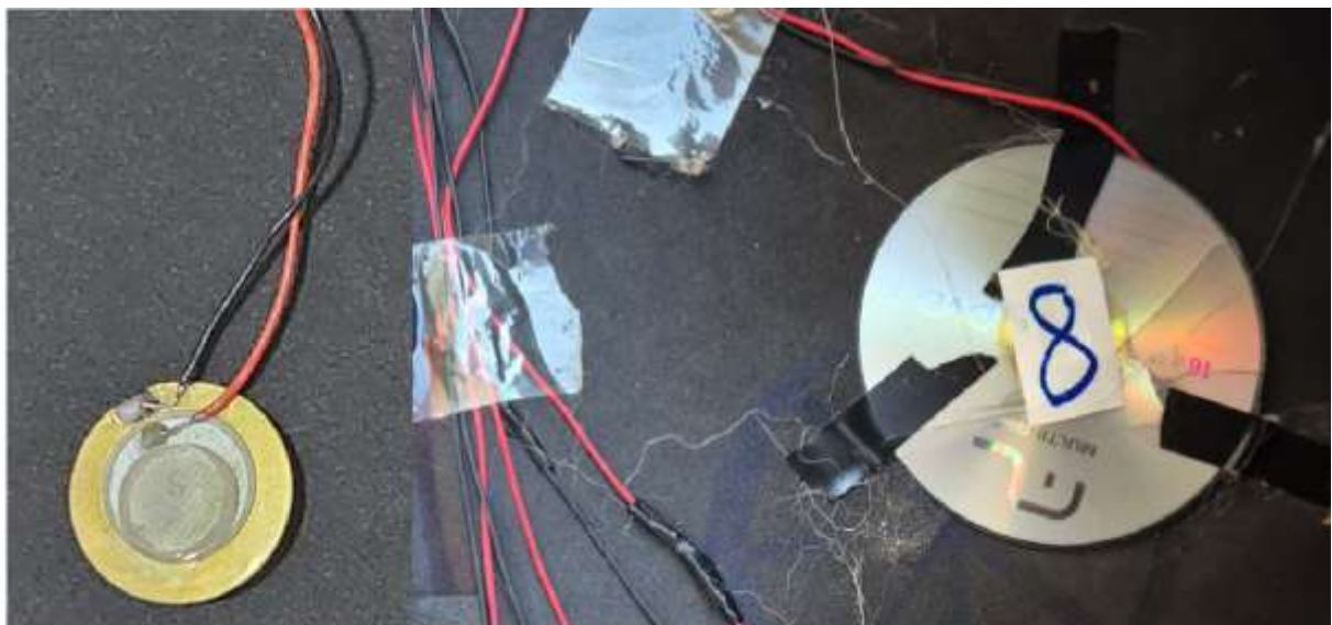
Figura 41: Sensor com peça de silicone e disco de acrílico.
