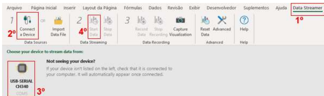
Figura 35: Quatro passos para conectar o Arduino no Excel.
