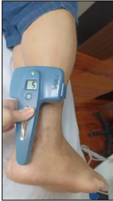
Figura 3. Avaliação do nervo sural com DPN Check®, aplicação dos biossensores com gel condutor e eletrodo em contato direto.
