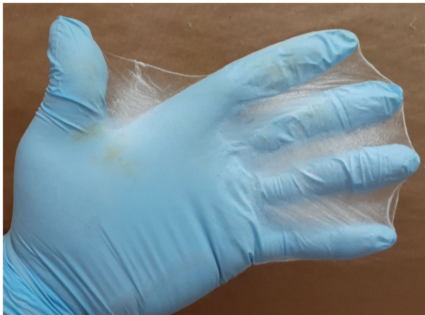
Figura 1.3 Fotografia de uma luva coberta por fibras produzidas pelo sistema de fiação por sopro em solução.
