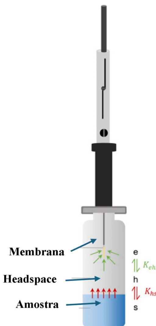
FIGURA 1.6 - Técnica de Headspace-SPME
