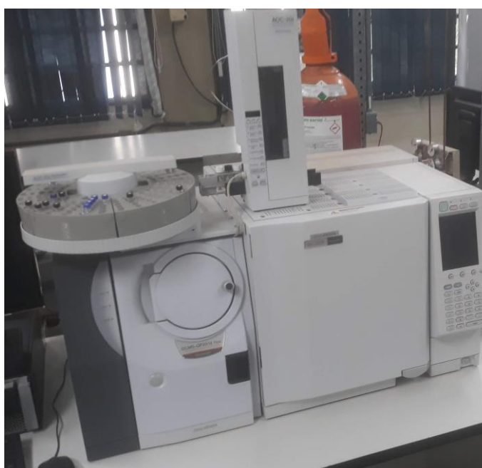
FIGURA 1.7 - Cromatógrafo em fase gasosa, acoplado ao espectrômetro de massas Shimadzu (QP2010-Plus).
